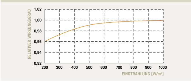
Die typische relative Änderung des Modulwirkungsgrades bezogen auf die Nennleistung bei einer Einstrahlung von 200 W/m<sup>2</sup> im Verhältnis zu 1000 W/m<sup>2</sup> beträgt -4 % rel. (gemessen bei 25 °C, AM 1,5 Spektrum).
